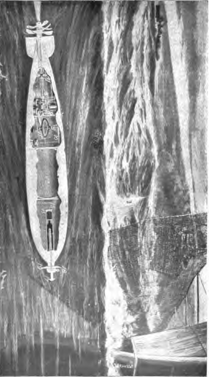
Durchschnitt eines Torpedob. Das vordere Drittel enthält die Sprengstoffladung, das mittlere Drittel zum Antrieb, das hintere die Maschinen.
