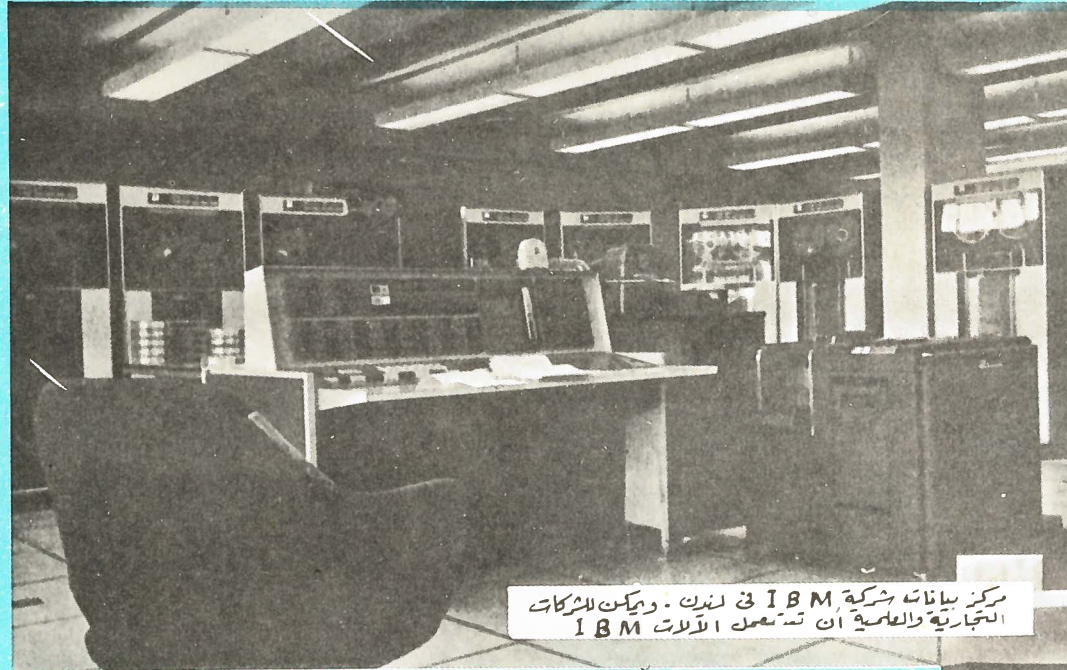
7320 أسطوانة ذاكرة مغناطيسية قادرة على احتضان أكثر من مليون عدد . ويمكن استعمال أكثر من ٧٠٠٠ أسطوانة مع جهاز حاسب واحد .
